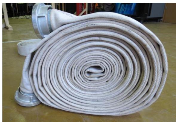
Slika 7: tlačna B-cev, dvojno zvita, brez cevnega nosilca
