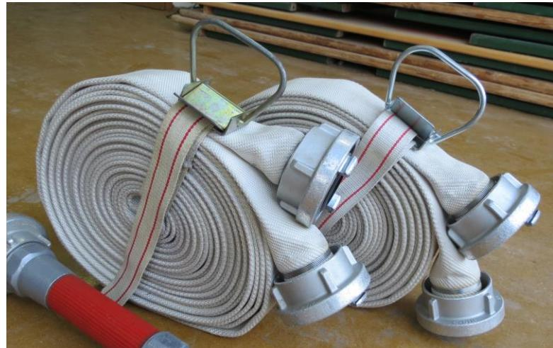
Slika 25: tlačne C-cevi (dolžina 15 m), dvojno zvite, brez cevnih nosilcev
