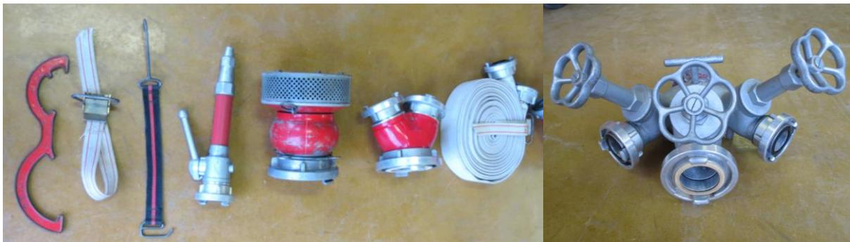
Slika 18: Spojni ključ, cevni nosilec, cevni pritrdilec, ročnik, sesalni koš, vodni zbiralec, C-cev in trojak za tekmovalca št. 2.
