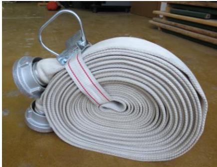
Slika 1: tlačna C-cev
