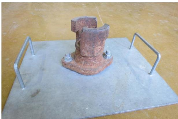
Slika 22: hidrantni nastavek C/C
