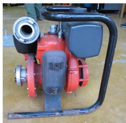
Slika 23: stabilna C-spojka
