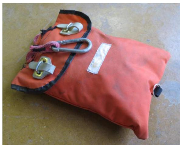
Slika 19: vezalna vrv, premera 8 mm, dolžine 15 m, v torbici
